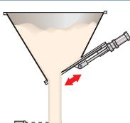
Tramoggia porzionatrice a ghigliottina ad azionamento pneumatico. Pareti assimetriche per facilitare la caduta della pasta.
